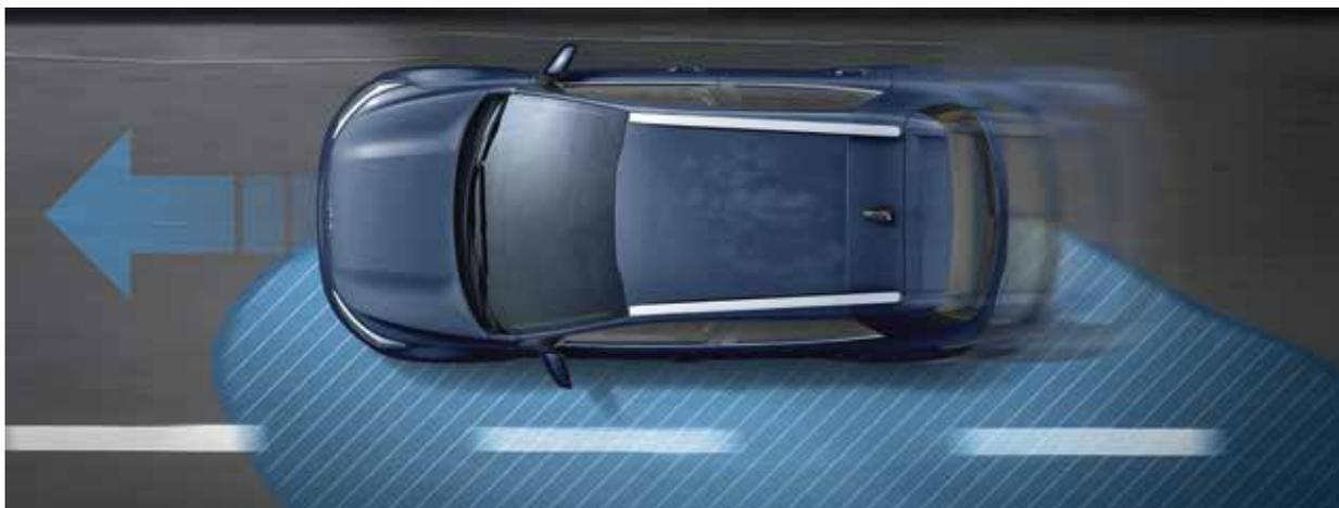
**Controllo dinamico della vettura (VSM).** Coadiuvato dalla tecnologia Motor Driven Power Steering, il controllo dinamico della vettura (VSM) contribuisce a garantire che Stonic non perda stabilità durante le frenate in curva.
