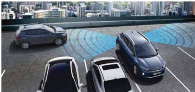
**Rear Cross-Traffic Collision Avoidance Assist (RCCA) e Rear Cross-Traffic Collision Warning (RCCW).** Quando si esce in retromarcia da un parcheggio o da una strada secondaria, il sistema RCCW avverte il conducente se rileva traffico incrociato nella corsia in cui il veicolo si sta immettendo. Il sistema RCCA riconosce invece la presenza di eventuali veicoli sulla traiettoria e applica automaticamente i freni per evitare una collisione.
