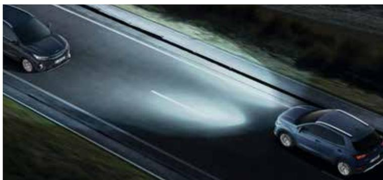
**High Beam Assist (HBA).** Reagendo automaticamente alla luminosità dei fari degli altri veicoli e alle condizioni della strada, il sistema HBA disattiva temporaneamente gli abbaglianti, per ridurre l'intensità del fascio luminoso che potrebbe colpire altri automobilisti.
