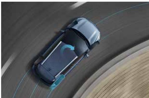
**Controllo della frenata in curva (CBC).** La funzione CBC, progettata per fare in modo che il veicolo mantenga la traiettoria in curva, applica una forza frenante simmetrica sulle singole ruote durante le frenate in curva, per contrastare ogni possibile perdita di trazione e aumentare la sicurezza.
