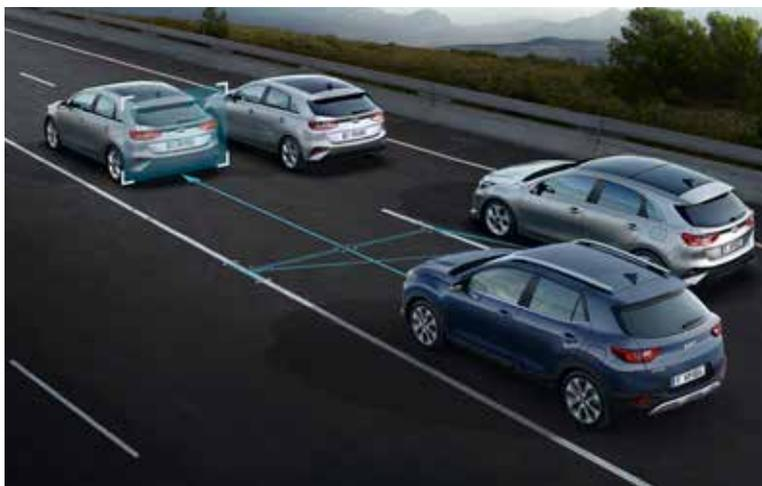
**Lane Following Assist (LFA).** Il sistema usa la telecamera anteriore e i sensori radar per mantenere la distanza di sicurezza dai veicoli davanti a sé, e legge la segnaletica orizzontale per mantenere l'auto al centro della corsia.
