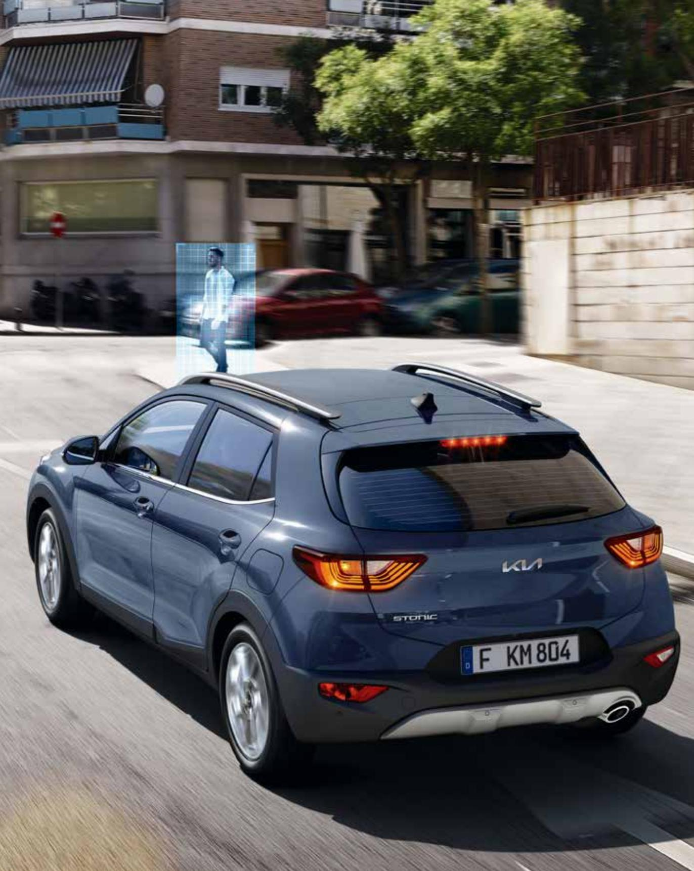
**Forward Collision-Avoidance Assist (FCA).** Combinando i dati del radar e della telecamera, il sistema FCA aziona i freni se rileva una frenata improvvisa da parte del veicolo che precede e può arrestare completamente un veicolo da una velocità di 60 km/h. Se il sistema FCA rileva la presenza di un pedone davanti, allerta il conducente e, in assenza di reazioni, frena al suo posto per evitare l'impatto o ridurne al minimo la gravità.
