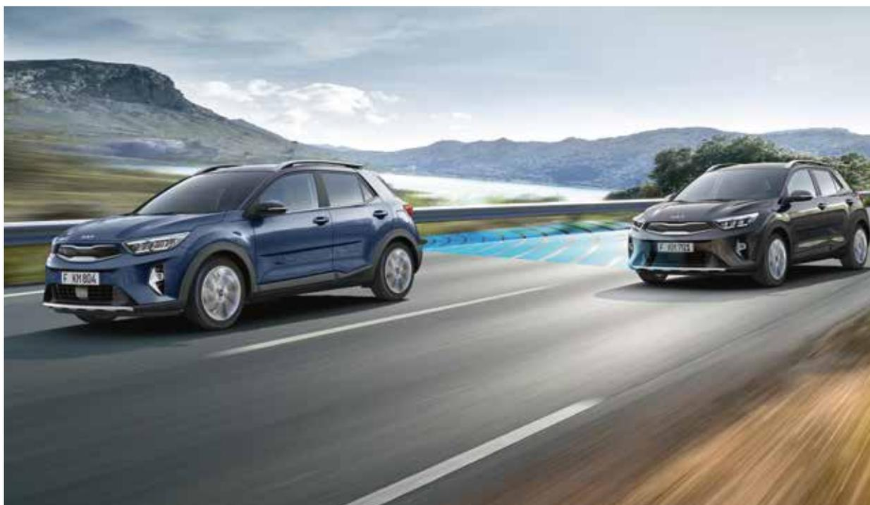
**Blind-Spot Collision Warning (BCW) e Blind-Spot Collision Avoidance Assist (BCA).** Quando vuoi cambiare corsia, il sistema BCW rileva l'eventuale presenza di veicoli nel punto cieco e attiva una spia nel retrovisore laterale e una sul cruscotto, accompagnate da un segnale acustico. Se inizi a cambiare corsia quando un veicolo è nel punto cieco, il sistema BCA di Stonic applica automaticamente i freni per evitare la collisione.
