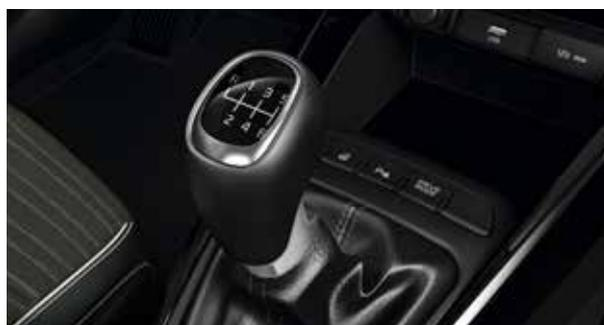
**Cambio manuale a 5 marce\*.** La trasmissione a 5 marce\* è garanzia di cambiate rapide e fluide e rapporti al cambio abbinati alle curve della coppia motrice, per incrementare la potenza e l'efficienza.
