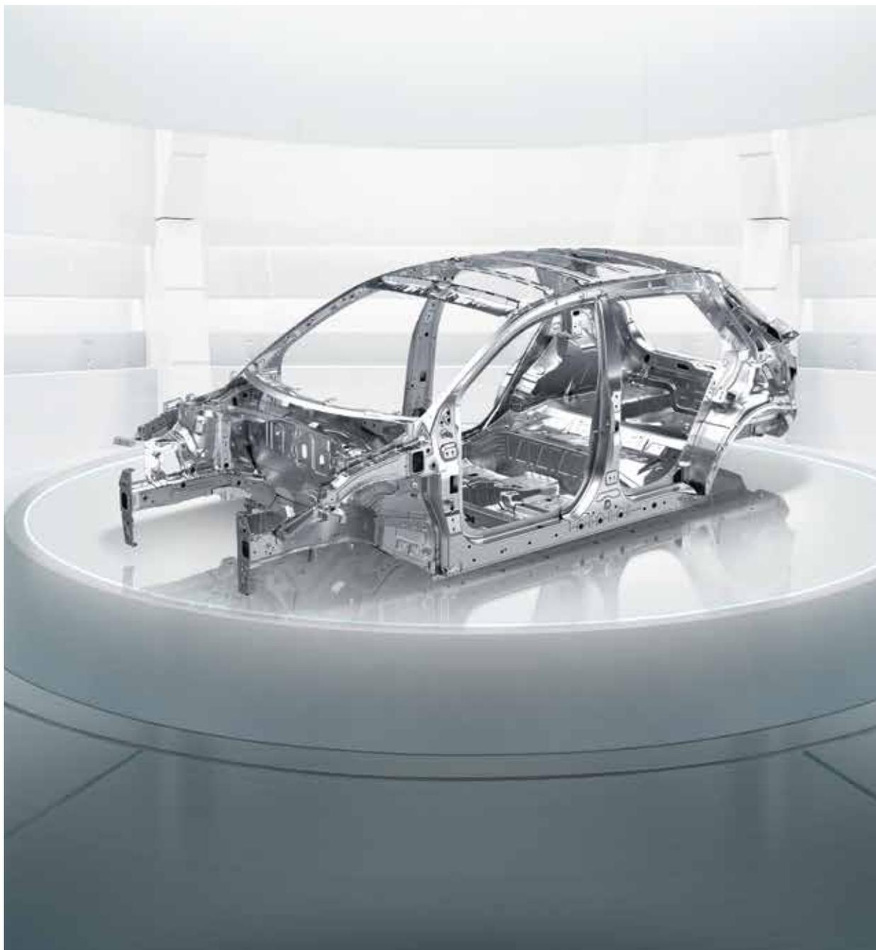
**Acciaio AHSS per aumentare la resistenza e la protezione dell'abitacolo.** Stonic è realizzata in acciaio altoresistenziale avanzato (AHSS) per offrire una scocca straordinariamente robusta e più rigida rispetto alla media, oltre che per incrementare la protezione dell'abitacolo e le prestazioni dinamiche dell'auto.
