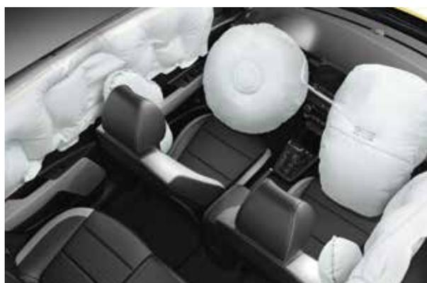
**6 airbag.** La protezione comprende gli airbag frontali per il conducente e il passeggero, due airbag laterali e due airbag a tendina che percorrono l'intera lunghezza dell'abitacolo.
