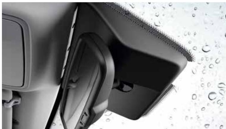
**Sensore pioggia.** Il sensore pioggia rileva la presenza di goccioline sul parabrezza e attiva i tergicristalli di conseguenza.
