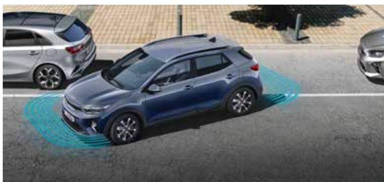
**Parking Distance Warning (PDW) anteriore/posteriore con pulsante on/off.** Nelle manovre di parcheggio in retromarcia, il sistema PDW usa i sensori a ultrasuoni montati nei paraurti per rilevare potenziali ostacoli. Il segnale acustico può essere disabilitato.
