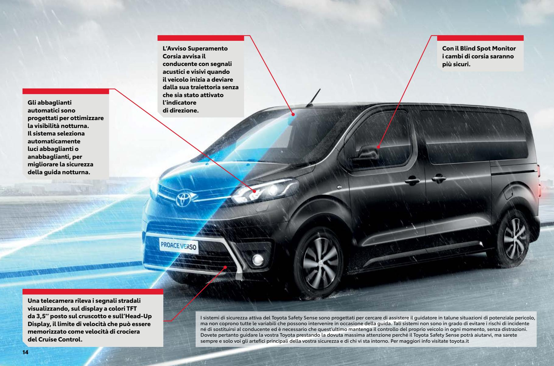
Gli abbaglianti automatici sono progettati per ottimizzare la visibilità notturna. Il sistema seleziona automaticamente luci abbaglianti o anabbaglianti, per migliorare la sicurezza della guida notturna.
