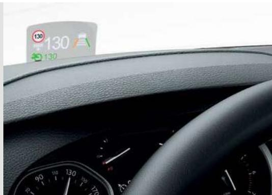
L'Head-Up Display di serie sull'allestimento Luxury proietta, su uno schermo posizionato esattamente sulla linea d'orizzonte del guidatore, una serie di informazioni essenziali alla guida, quali la velocità, le impostazioni del Cruise Control e gli avvisi di sicurezza.
